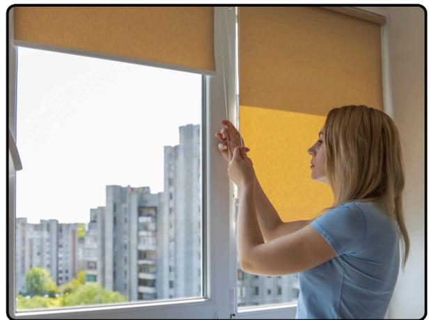
Están hechas generalmente de poliéster y PVC. El tejido tiene una estructura microperforada que permite la entrada de luz natural mientras reduce el deslumbramiento. Ofrecen distintos grados de apertura (normalmente entre el 1% al 5%), lo que determina la cantidad de luz y la visibilidad hacia el exterior.
